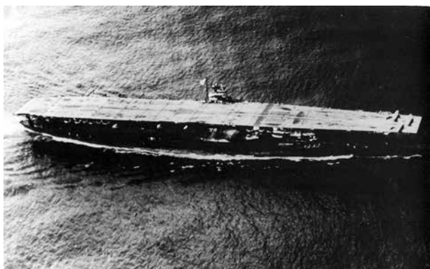
赤城號改裝試航上、下層甲板未封閉
