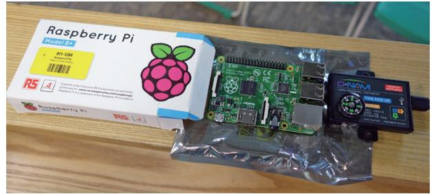
Raspberry Pi (如名片大小的電腦樹莓派)+Sensor(小型微機電地震儀感測器)
