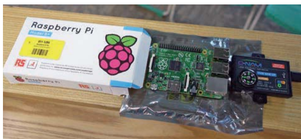
Raspberry Pi (如名片大小的電腦樹莓派)+Sensor(小型微機地震儀感測器)
