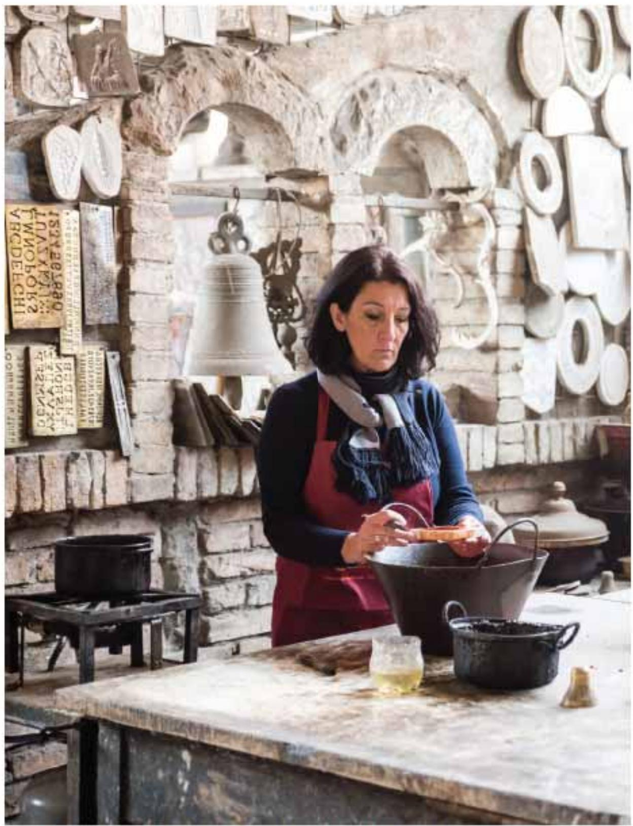
每口鐘外表都有凸出的圖像，廠內四周牆上就掛著數百個圖像模型。雕塑家 Paola Patriarca 用蠟注入一個模型，再將該模型壓在鐘模之上。
